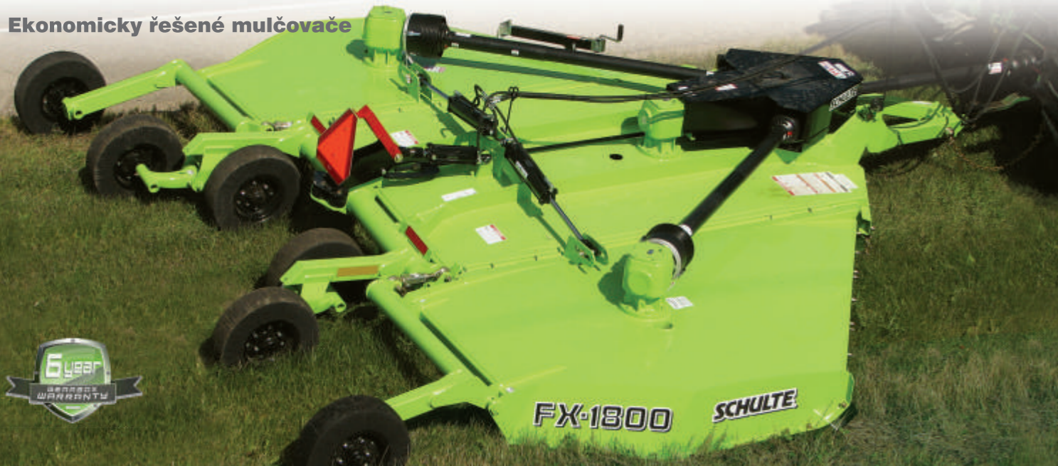
Rozdílný smysl otáčení nožů přispívá k lepšímu rozptýlení materiálu
